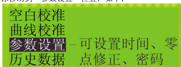
在此状态下，按“确认”键，仪器将提示输入密码：
